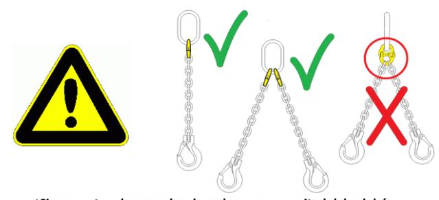
¡Si se montan dos ramales de cadena en una mitad del eslabón de unión para el uso alternativo de los ramales, solamente puede someterse a esfuerzo un ramal!
