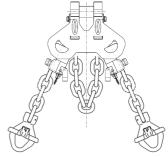
Achten Sie dabei darauf, dass die Kette nicht verdreht ist und beide Kettenenden so positioniert sind, dass nach Montage der Anschlagmittel diese bei Benutzung am Containerzapfen keine Verdrehung der Kette verursachen!
