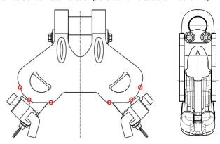
Kontrollieren Sie regelmäßig das leichtgängige Schwenken der Kettenkonsolen in den Seitenblechen. Klemmende Kettenkonsole deuten auf Verformungen hin. Nehmen Sie M3-Laschen sofort außer Betrieb, wenn Sie starke Verformungen der Seitenbleche erkennen.
